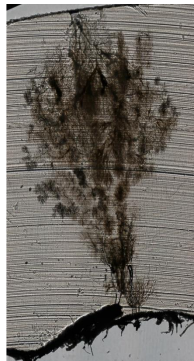
3kV CV (経年27年)
