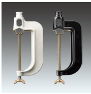
F4/W (BK) ¥2,100 質量：240g 万力式に丸棒・丸パイプはφ70mm、平板は100mmまで取付できます。移動を必要とする工事現場の照明に使用します。 ※パイプは最大締付トルクの8.8Nm以下で締付けてください。
