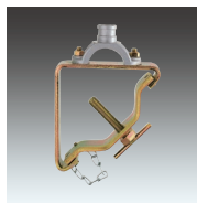
F11 ¥3,600 質量：500g 角棒なら60mm、平板なら100mm、アングル(等辺山形鋼)なら80mm、丸棒・丸パイプならφ70mm以下の支持物に取付けられます。
