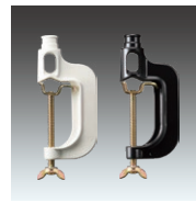
F3/W (BK) ¥1,650 質量：170g 万力式に丸棒・丸パイプはφ50mm、平板は60mmまで取付できます。移動を必要とする工事現場の照明に使用します。 ※パイプは最大締付トルクの8.8Nm以下で締付けてください。
