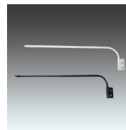
F13/W (BK) ¥5,300 質量：1.4kg アーム長：965mm ※電源引出部は必ず下向きに取付けてください。風の強い地域でご使用の場合は、F13-Bを用いワイヤなどでアームを左右から支持してください。
