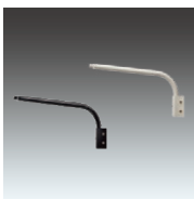
F13M/W (BK) ¥5,300 質量：1.0kg アーム長：465mm ※電源引出部は必ず下向きに取付けてください。風の強い地域でご使用の場合は、F13-Bを用いワイヤなどでアームを左右から支持してください。
